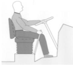
Progettazione ad hoc di sedili antivibranti passivi (meccanici, idraulici, pneumatici) o attivi (Active Vibration Control)
